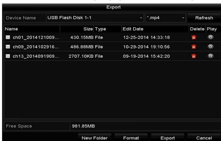
Figure 7.4 Ergebnisprüfung beim Schnell-Export mittels USB1-1
