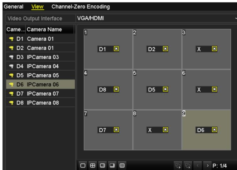
Figure 3. 8 Liveansicht – Kamerareihenfolge
