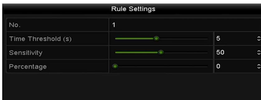
Figure 9.8 Regeln für die Einbrucherkennung festlegen
