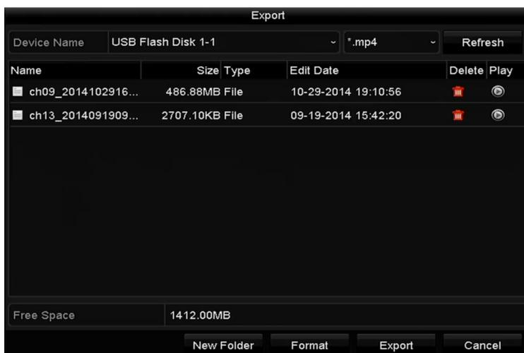
Figure 7.2 Schnell-Export mittels USB1-1
