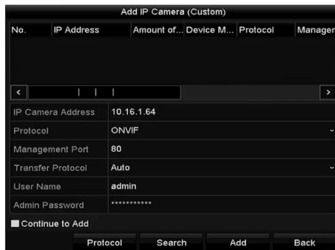
Figure 2. 22 Benutzerdefinierte Hinzufügung von IP-Kameras
